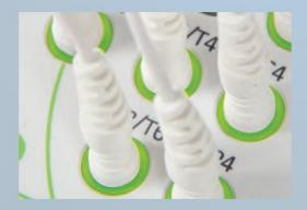
O redor do conector touch-proof no amplificador brilha em verde se a impedância for boa e em vermelho se estiver ruim. O valor numérico da impedância é exibido na janela "Medição de Impedância" do software.
